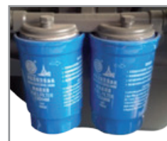
Sistema de doble filtro de combustible
