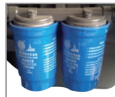
Sistema de doble filtro de combustible
