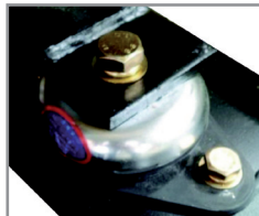
Amortiguadores de vibración.
