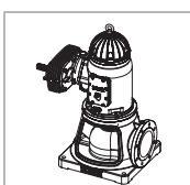
**Testata di comando OM con rinvio ad angolo con moltiplicatore per collegamento alla presa di forza mediante albero cardanico**
