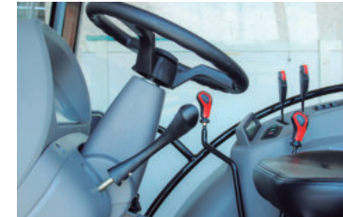
Volante ajustable con dirección hidráulica y panel de control dinámico Americano.
