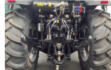
Sistema Categoría II con capacidad de hasta 4.5T.f (2T.f 610mm), control de posición, profundidad y sobrecarga. Tiro y Swing draw-Bar.
