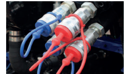
Caja de Válvulas doble y 2 remotas auxiliares.
