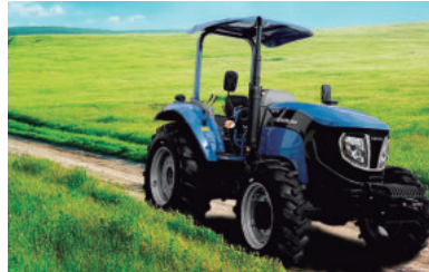
Diseño aerodinámico (visibilidad de llantas frontales), luces LED y rROPS (Roll Over Protective Structure).
