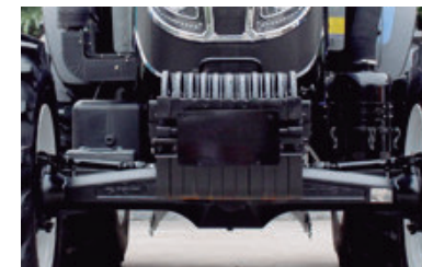
Transmisión 4WD 4x4 estándar con eje frontal reforzado sellado, aplicación Heavy Duty, alto despeje frontal y radio de giro regulable hasta 3.4m
