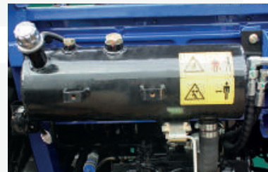
Tanque auxiliar de aceite hidráulico, con Power Lifter de 58L.
