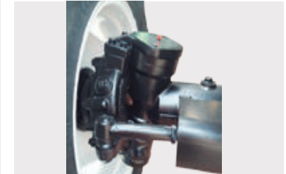
Eje delantero impermeable sellado para uso severo en campos de arroz y fango.
