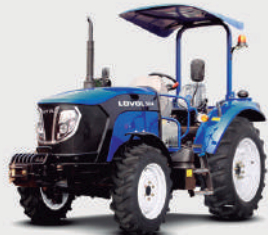
Diseño aerodinámico (visibilidad de llantas frontales), luces LED y Barra Antivuelco estándar plegable ROPS (Roll Over Protective Structure)
