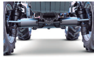
Transmisión 4WD 4x4 estándar con eje frontal reforzado sellado, aplicación Heavy Duty, alto despeje frontal y radio de giro regulable hasta 3.2m
