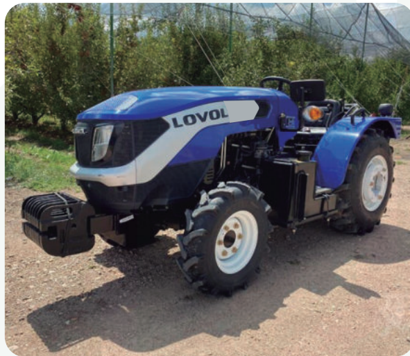
Tractor Angosto y bajo con 1.31m de ancho y 1.3 de Alto (Sin ROPS). Ideal para Invernaderos, Productores de cítricos, Café, Frutas, y otros cultivos con pasos angostos y eficientes.
