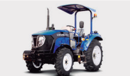
Diseño aerodinámico (visibilidad de llantas frontales), luces LED y Barra Antivuelco estandar plegable ROPS (Roll Over Protective Structure)
