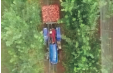
Tractor Frutero, Angosto y de Baja Altura, con un potente motor de 60HP.
