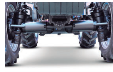
Transmisión 4WD 4x4 estandar con eje frontal reforzado sellado, aplicación Heavy Duty, alto despeje frontal y radio de giro regulable hasta 3.2m
