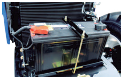
Batería libre de mantenimiento, para larga duración y precalentador para arranque en frío.
