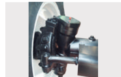
Eje delantero impermeable sellado para uso severo en campos de arroz y fango.
